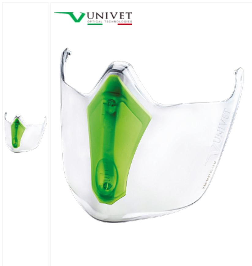
· Ударопрочный щиток для защиты нижней части лица от летящих твердых и жидких частиц. · Имеет регулируемую вентиляцию. · Совмещается с закрытыми очками модели 6X3, быстро и надежно крепится к ним. · Доступен для ношения поверх респираторов. Материал: поликарбонат Цвет: светло-серый Защитные свойства: от механических воздействий (удары частиц со скоростью 120м/с) Вес: 57 г
