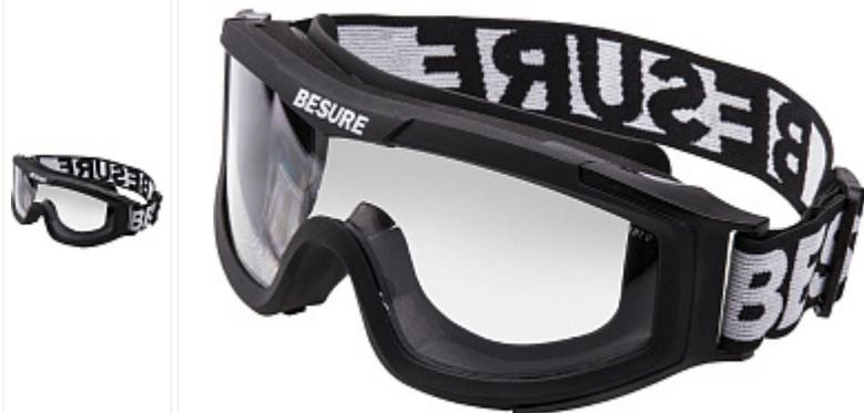
ОЧКИ ЗАЩИТНЫЕ «BESURE TACTIC» ПРОЗРАЧНЫЕ Оправа: термополиуретан Линза: поликарбонат Толщина линзы: 2,8 мм Оптический класс: №1 Покрытие: от царапин, от запотевания Защита: от механических воздействий, ультрафиолетовых лучей Вентиляция: непрямая Крепление ленты оголовья: фиксированное Вес: 114 г Особенность модели: огнестойкая оправа Стандарты: ТР ТС 019/2011, ГОСТ 12.4.253-2013
