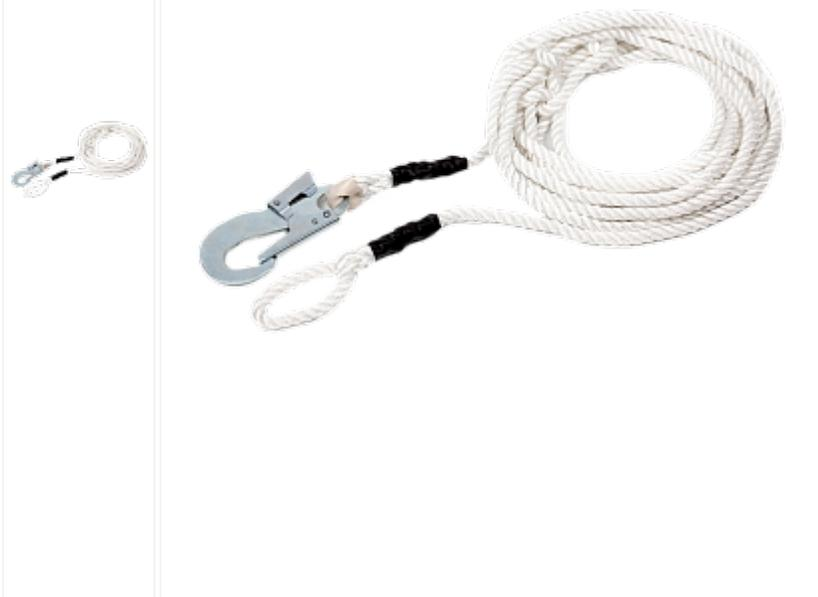
Строп спасательный из полиамидного каната ф 11 мм с карабином используется для удлинения фала пояса предохранительного ляточного и совместно с этим поясом предназначен для страховки и экстренной эвакуации человека, работающего в траншеях, колодцах, ёмкостях и др. замкнутых пространствах Срок службы стропа 5 лет. Статическая разрывная нагрузка стропа –не менее 15кН. ГОСТ Р 50849-96, ТУ 5225-001-64973906-2011
