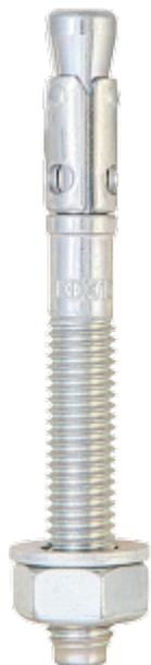
Клиновой анкер предназначен для установки шлямбурных ушей в скальной породе при пробивке маршрутов. Анкер из оцинкованной стали состоит из распорной втулки, шпильки с резьбой и конусным концом, а также фиксирующей гайки с шайбой. При закручивании гайки конусная часть раздвигает стенки втулки, надежно фиксируя анкер в толще скальной породы. Особенности Длина анкера составляет 100 мм Диаметр 10 Материал — оцинкованная сталь Масса: 195 г
